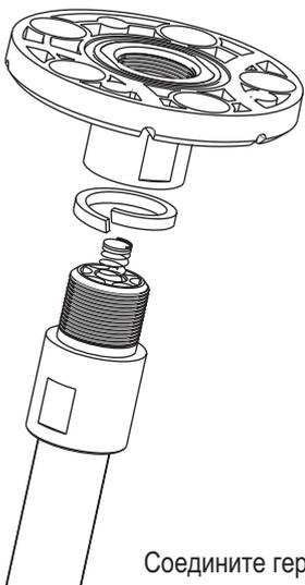
Соедините герметизирующую прокладку с фланцем крепления датчика. Для этого совместите крепежные конусы с отверстиями в нижней части фланца и надавите на прокладку. Прокладка надежно соединится с фланцем крепления датчика.
