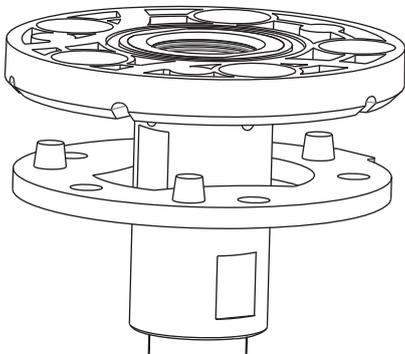
Вставьте в просверленное отверстие топливного бака измерительную трубку с фланцем и герметизирующей прокладкой. Закрепите фланец на топливном баке с помощью саморезов крепления.
