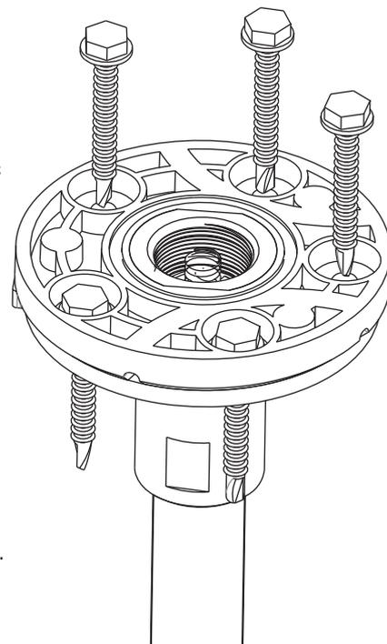
Вставьте лейку в центральное отверстие фланца и залейте в бак 200 грамм топлива. Это необходимо сделать для смачивания поверхностей измерительной трубки и центрального стержня. Тарировка топливного бака с сухой измерительной трубкой будет не правильной.
