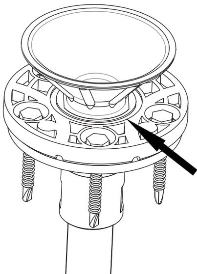
Накрутите измерительную головку датчика на фланец.
